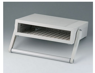
B2210107 MEDITEC D 220, avec poignée étrier ABS (UL 94 HB) gris blanc RAL 9002 290x260x74mm IP 40
