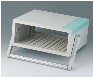
B2210305 MEDITEC D 220, avec poignée étrier ABS (UL 94 HB) gris blanc RAL 9002 290x260x124mm IP 40
