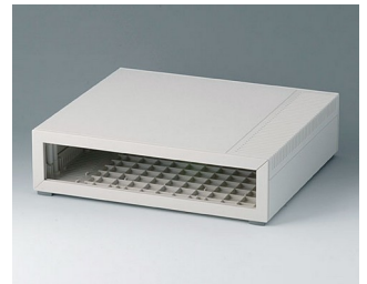
B2210007 MEDITEC D 220, sans poignée étrier ABS (UL 94 HB) gris blanc RAL 9002 290x260x74mm IP 40
