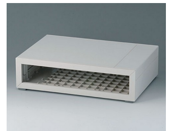
B2211017 MEDITEC D 160, sans poignée étrier ABS (UL 94 HB) gris blanc RAL 9002 290x200x74mm IP 40
