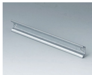
C7111087 Barrette normalisée, type TH 15 Acier 104x15x5,5mm
