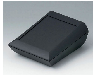
A0612109 COMTEC 120 H, Vers. I ABS (UL 94 HB) noir RAL 9005 120x150x62,8mm IP 40
