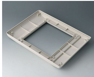
B4046717 Partie inférieure L plate, version II ABS (UL 94 HB) gris blanc RAL 9002 275x195x26,5mm IP 54 opt.
