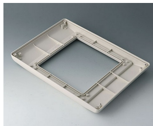
B4046707 Partie inférieure L plate, version I ABS (UL 94 HB) gris blanc RAL 9002 275x195x26,5mm IP 54 opt.
