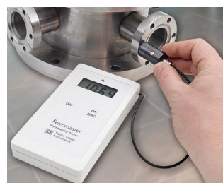
Ferromaster, l'instrument de mesure de la perméabilité
