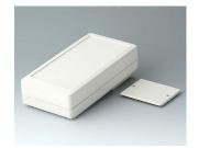
A9074127 DATEC-MOBIL-BOX M, Vers. I, surélevé ABS (UL 94 HB) gris blanc RAL 9002 195x101x59mm IP 65 opt.
