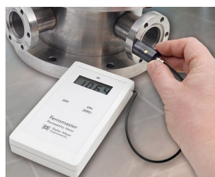
Ferromaster, l'instrument de mesure de la perméabilité
