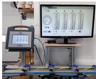
Système de surveillance pour les buses de nettoyage
