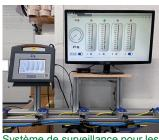
Système de surveillance pour les buses de nettoyage
