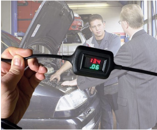
Affichage de la tension et du courant en mode maintien de charge
