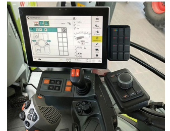
Joystick numérique pour machines bus ISO
