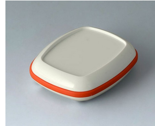
B1604207 BODY-CASE M, avec zone en creux ASA (UL 94 HB) blanc signalisation RAL 9016 50x41x14mm IP 65
