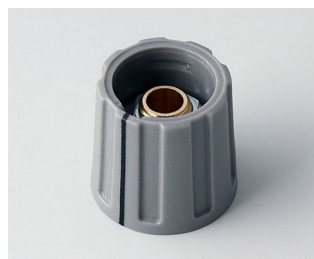
A2616068 BOUTON ROND 16, avec trait ABS (UL 94 HB) gris poussière RAL 7037 16x15mm 6mm
