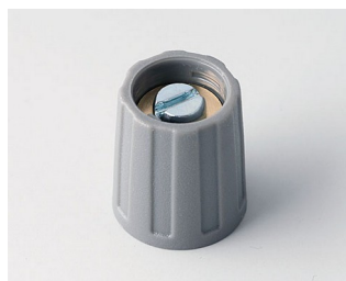
A2513048 BOUTON ROND 13,5, sans trait ABS (UL 94 HB) gris poussière RAL 7037 13x15mm 4mm
