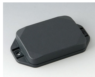
B1824128 MINI-DATA-BOX EF50, plate avec bride ASA+PC (UL 94 V-0) gris anthracite RAL 7016 70x50x15mm IP 65 opt., IP 40
