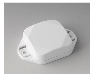
B1802127 MINI-DATA-BOX SF40, plate avec bride ASA+PC (UL 94 V-0) blanc signalisation RAL 9016 40x40x15mm IP 65 opt., IP 40
