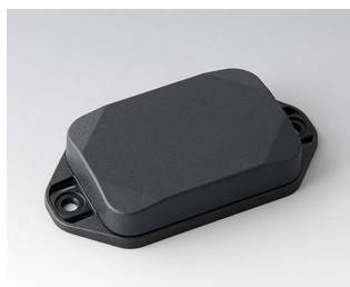
B1822128 MINI-DATA-BOX EF40, plate avec bride ASA+PC (UL 94 V-0) gris anthracite RAL 7016 60x40x15mm IP 65 opt., IP 40
