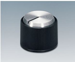
A1318260 BOUTON, à fixation latérale par vis ABS (UL 94 HB) noir/alu 18,2x14,2mm 6mm
