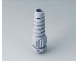
C2316518 Passe-câble à vis M16x1,5 PA 6 gris argent RAL 7001
