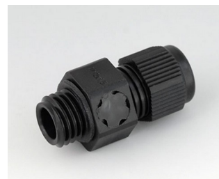
C2312919 Passe-câble M12x1,5 avec compensation de pression intégrée PA 6 (UL 94 V-0) noir RAL 9005
