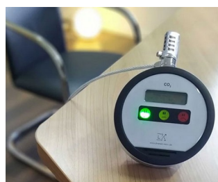
Feu de signalisation CO2
