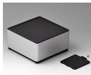
ES146059 SYNERGY S140 Aluminium AIMgSi 0,5 anodisé mat 140x140x70mm IP 40
