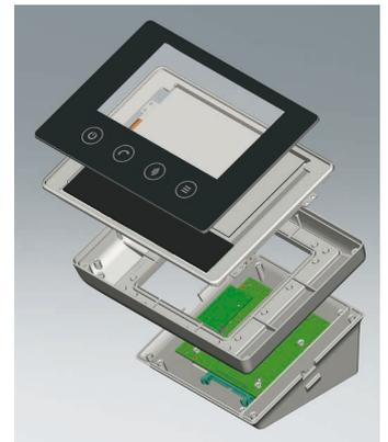
**Aufbau eines INTERFACE-TERMINAL als Displaygehäuse (Explosionszeichnung)**
