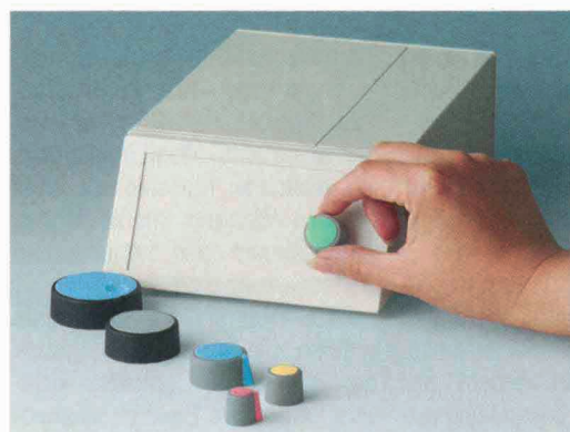
Die Montage der COM-KNOBS erfolgt von vorne über eine sichere Spannzangenbefestigung für elektromechanische Drehpotentiometer mit runden Wellenenden nach DIN 41 591
