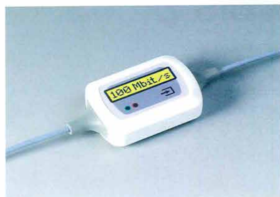
03 Auf der abgeflachten Gehäuseschale lässt sich ein kompaktes Anzeigendisplay installieren
