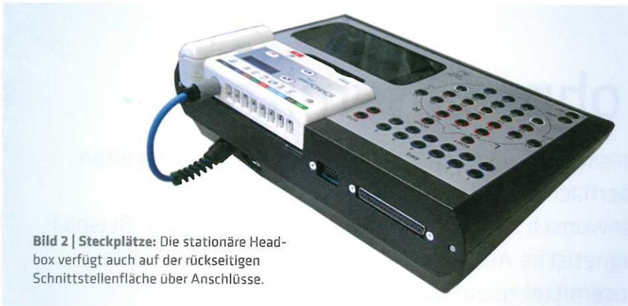
**Bild 2 | Steckplätze:** Die stationäre Headbox verfügt auch auf der rückseitigen Schnittstellenfläche über Anschlüsse.
