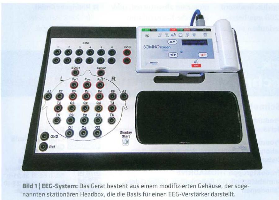
**Bild 1 | EEG-System:** Das Gerät besteht aus einem modifizierten Gehäuse, der sogenannten stationären Headbox, die die Basis für einen EEG-Verstärker darstellt.
