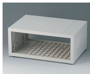
B2211217 MEDITEC D 160, ohne Griffbügel ABS (UL 94 HB) grauweiß RAL 9002 290x200x124mm IP 40
