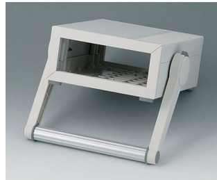
B2213107 MEDITEC E 160, mit Griffbügel ABS (UL 94 HB) grauweiß RAL 9002 160x200x74mm IP 40
