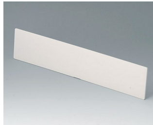
B2129307 Front-/ Rückplatte D, flach ABS (UL 94 HB) grauweiß RAL 9002 271,6x55,6x3mm
