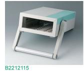
MEDITEC E 220, mit Griffbügel ABS (UL 94 HB) grauweiß RAL 9002 160x260x74mm IP 40
