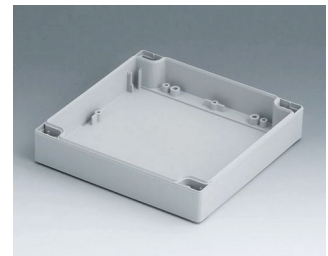
C0161602 Gehäuseschale 160, mit Feder PC (UL 94 HB) lichtgrau RAL 7035 160x160x30mm
