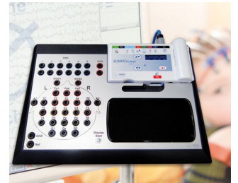
Stationäres System für Langzeit-EEG-Aufzeichnungen
