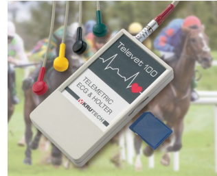
Telemetrisches EKG System für die Veterinärmedizin
