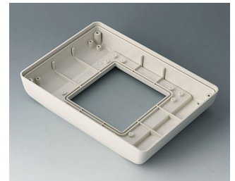
B4042767 Unterteil S hoch, Ausf. II ABS (UL 94 HB) grauweiß RAL 9002 190x135x34,5mm IP 54 opt.
