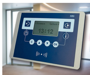
Terminal für die Personalzeiterfassung
