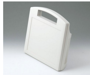
B4210107 CARRYTEC M ABS (UL 94 HB) grauweiß, RAL 9002 270x247x91mm IP 54 opt.
