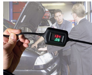
Spannungs- und Stromanzeige bei der Erhaltungsladung
