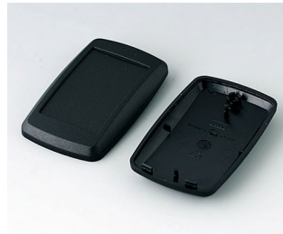
B9004806 Unter- und Oberteil EM PMMA (IR) (UL 94 HB) schwarz RAL 9005 68x42x18mm
