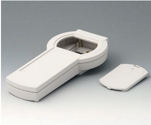
A9077207 DATEC-CONTROL S, Ausf. II ABS (UL 94 HB) grauweiß RAL 9002 228x117x47mm IP 65 opt.
