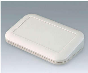
A9446107 EVOTEC 150, Ausf. III ASA+PC-FR (UL 94 V-0) grauweiß RAL 9002 150x93x36mm IP 65 opt., IP 40
