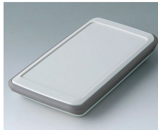
B5403317 SLIM-CASE M, Ausf. VI ASA+PC-FR (UL 94 V-0) grauweiß RAL 9002 148x74x22mm IP 54
