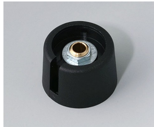
A3023049 COM-KNOBS 23, mit Ausparung PA 6 nero 23x16mm 4mm
