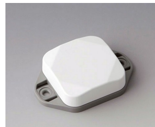
B1802126 MINI-DATA-BOX SF40, flach, mit Flansch ASA+PC (UL 94 V-0) verkehrsweiß RAL 9016 40x40x15mm IP 65 opt., IP 40
