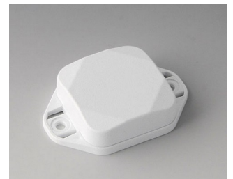
B1802127 MINI-DATA-BOX SF40, flach, mit Flansch ASA+PC (UL 94 V-0) verkehrsweiß RAL 9016 40x40x15mm IP 65 opt., IP 40
