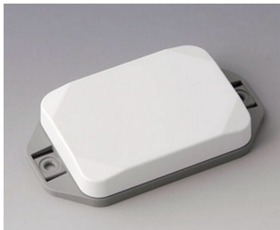
B1824126 MINI-DATA-BOX EF50, flach, mit Flansch ASA+PC (UL 94 V-0) verkehrsweiß RAL 9016 70x50x15mm IP 65 opt., IP 40
