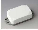
B1822226 MINI-DATA-BOX EF40, hoch, mit Flansch ASA+PC (UL 94 V-0) verkehrsweiß RAL 9016 60x40x20mm IP 65 opt., IP 40
