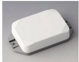
B1824226 MINI-DATA-BOX EF50, hoch, mit Flansch ASA+PC (UL 94 V-0) verkehrsweiß RAL 9016 70x50x20mm IP 65 opt., IP 40
