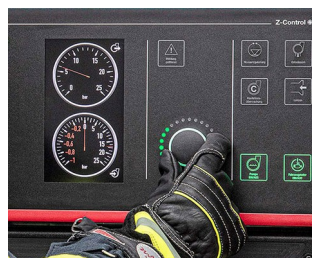
Bedienelement für Pumpenbedienstand
