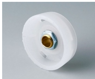
B8333061 STAR-KNOBS 33, mit Noppen PC (UL 94 HB) diamant 33x14mm 6mm
