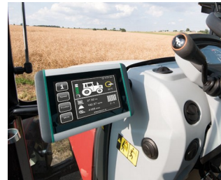
ISOBUS-Terminal für Traktoren und selbstfahrende Arbeitsmaschinen
