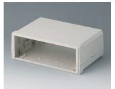
B3020127 MOTEC M, flach/hoch ABS (UL 94 HB) grauweiß RAL 9002 205x140x75mm IP 40
