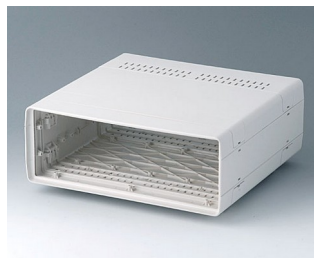
A0224170 EUROPA-GEHÄUSE 42 TE, o. Griffb. ABS (UL 94 HB) grauweiß RAL 9002 260x250x98,5mm
