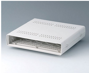
A0214270 EUROPA-GEHÄUSE 42 TE, o. Griffb. ABS (UL 94 HB) grauweiß RAL 9002 260x250x54mm
