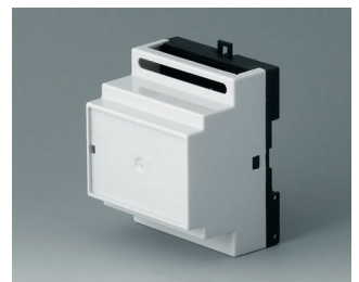
B6503117 RAILTEC B, 4 Module, Ausf. IV PC (UL 94 V-0) lichtgrau RAL 7035 70x86x58mm
