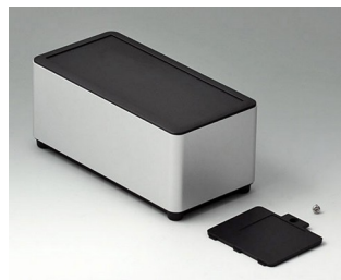
EE166059 SYNERGY E160 Aluminium AlMgSi 0,5 matt eloxiert 160x80x70mm IP 40
