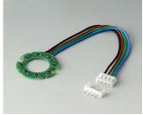
B7546001 LED-Beleuchtung, 8 LEDs (RGB Backlight)
