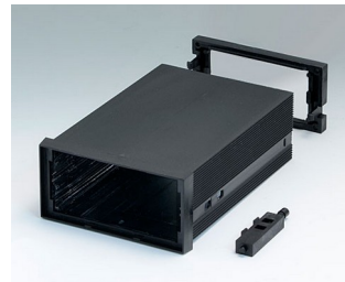
B6032072 NORM-EINBAUGEHÄUSE TYP A, Ausf. II PPO (UL 94 V-0) schwarz RAL 9005 96x48x131mm
