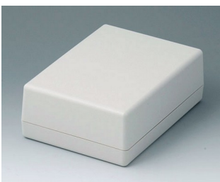
A9413341 SCHALENGEHÄUSE G 190, Ausf. I ABS (UL 94 HB) grauweiß RAL 9002 138x190x68mm IP 65 opt.
