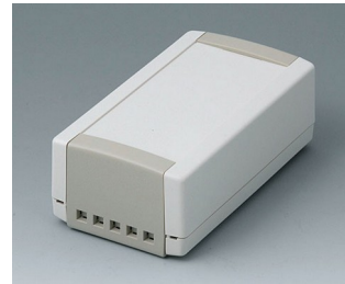
B1050465 TOPTEC 123 H, Ausf. II ABS (UL 94 HB) grauweiß RAL 9002 123x68x45mm IP 40
